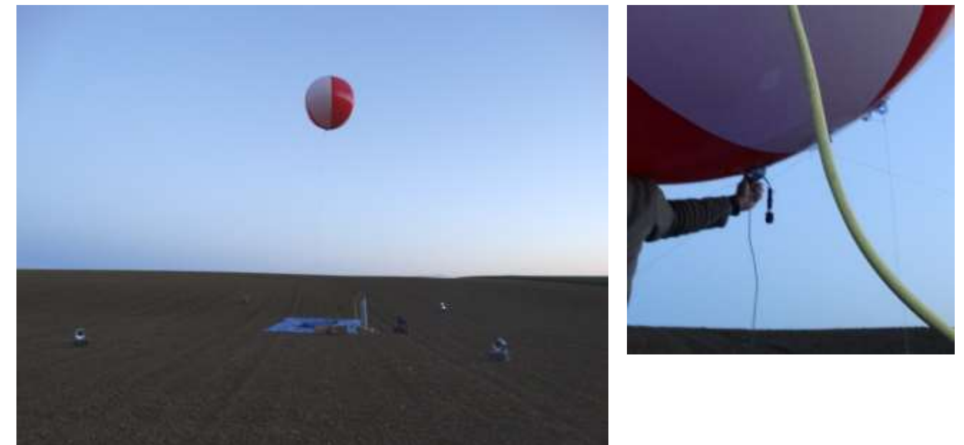
Photographie 2 : Ballon captif gonflé, avec micro et ancré au sol
